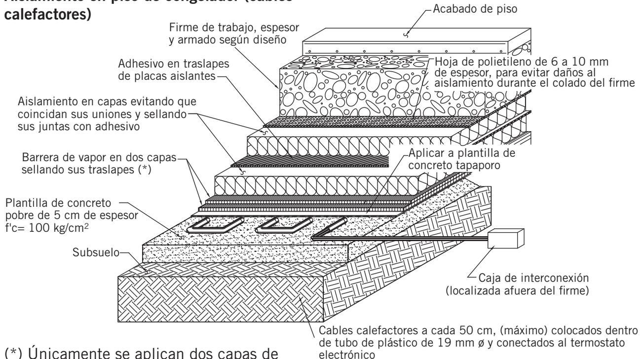
(\*) Únicamente se aplican dos capas de barrera de vapor y la malla de refuerzo poliéster en las barreras de vapor asfálticas, en las barreras de vapor autoadheribles solamente se necesita una capa y no se requiere la malla de refuerzo poliéster.
