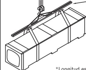
Balancín de 6 m para repartir uniformemente el peso del paquete al momento de levantarlo.
