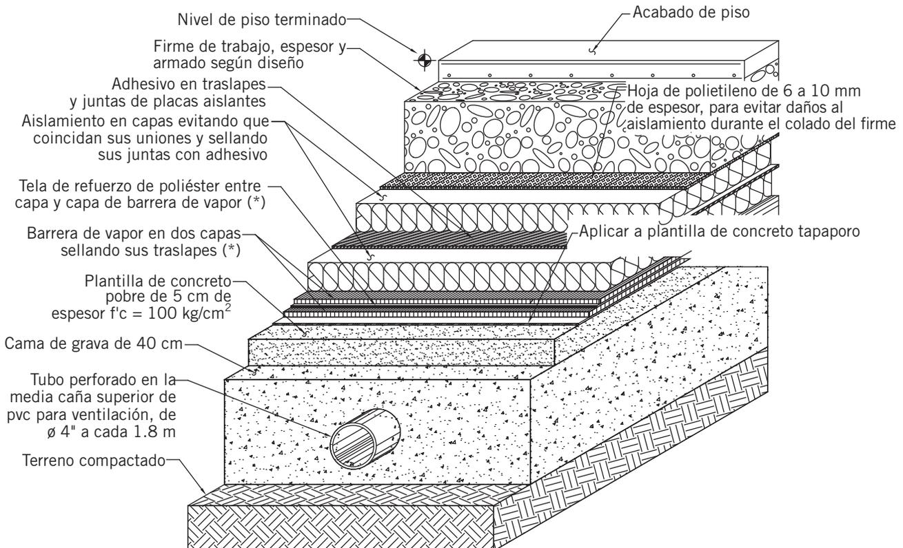
(\*) Únicamente se aplican dos capas de barrera de vapor y la malla de refuerzo poliéster en las barreras de vapor asfálticas; en las barreras de vapor autoadheribles solamente se necesita una capa y no se requiere la malla de refuerzo poliéster.
