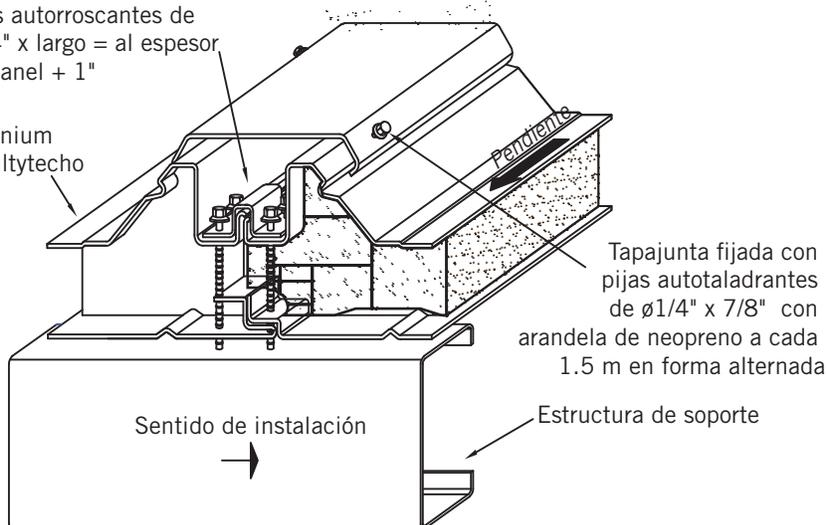
Tapajunta fijada con pijas autotaladrantes de  $\varnothing$ 1/4" x 7/8" con arandela de neopreno a cada 1.5 m en forma alternada
